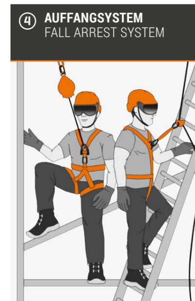
Ein Auffangsystem fängt Abstürze, indem es den freien Fall begrenzt und die Fangstoßkraft beim Auffangvorgang reduziert. Daher ist die Verwendung von energieabsorbierenden Komponenten wie Falldämpfer oder Höhensicherungsgeräte zwingend erforderlich!
